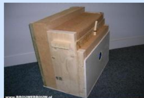
Optimaal geïsoleerde HSB-wand ( Rc > 8,0 )
