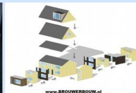
Prefab HSB-modules voor woningverbetering
